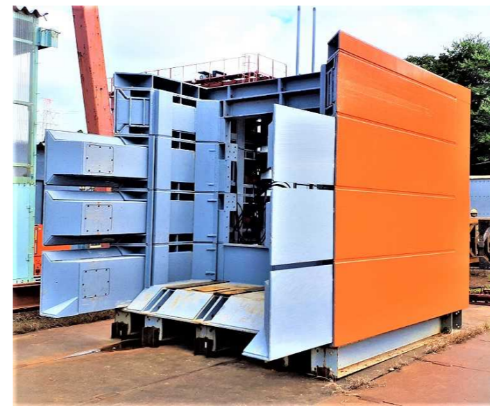
施工状況：オープンシールド機
